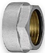
Изготавливается из покрытой латуни. Внутренняя резьба трубная цилиндрическая G3/4" Евроконус по DIN EN ISO 228-1, ГОСТ 6357. Для присоединения металлополимерных труб MLC к радиаторным узлам и коллекторам с наружной резьбой 3/4" Евроконус.
