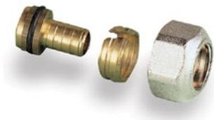
Изготавливается из покрытой латуни. Внутренняя резьба трубная цилиндрическая G1/2" по DIN EN ISO 228-1, ГОСТ 6357. Для присоединения труб PE-Xa 10 бар (S3,2) к радиаторным узлам и коллекторам с наружной резьбой 1/2" (конус).
