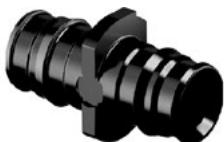
Полимерные фитинги из полифенилсульфона PPSU для соединения труб из сшитого полиэтилена PE-Xa. Технология соединения трубы с фитингом основана на способности труб из сшитого полиэтилена восстанавливать свою первоначальную форму после расширения благодаря молекулярной памяти. Фитинги универсальны для труб серий S5,0 и S3,2 (PN6 и PN10). Кольца для монтажа следует заказывать отдельно.
