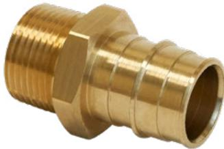
Фитинги из латуни для соединения труб из сшитого полиэтилена РЕ-Ха с отопительными и санитарными приборами, резьбовыми коллекторами, запорно-регулирующей арматурой и т.п. Технология соединения трубы с фитингом основана на способности труб из сшитого полиэтилена восстанавливать свою первоначальную форму после расширения благодаря молекулярной памяти. Наружная резьба – трубная коническая R по DIN EN 10226-1, ГОСТ 6211.
