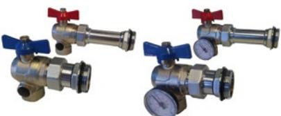
Изготавливается из покрытой латуни. Угловое исполнение. Наружная резьба 1"НР, внутренняя резьба 3/4"ВР. Наружная резьба со встроенной торцевой уплотнительной прокладкой под плоское уплотнение. Длина 94/142 мм. В комплект входят два крана. Арт.1135965 имеет встроенный термометр со шкалой 0÷80°C.
