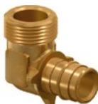
Фитинги из латуни для соединения труб из сшитого полиэтилена РЕ-Ха с отопительными и санитарными приборами, резьбовыми коллекторами, запорно-регулирующей арматурой и т.п. Технология соединения трубы с фитингом основана на способности труб из сшитого полистиленса восстанавливать свою первоначальную форму после расширения благодаря молекулярной памяти. Наружная резьба – трубная коническая R по DIN EN 10226-1, ГОСТ 6211.
