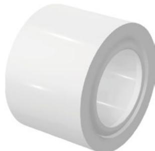
Изготавливается из сшитого полиэтилена PE-X. Кольца используются для монтажа соединений труб USYSTEMS PE-Xa с фитингами из латуни или PPSU, монтируемыми с помощью расширительного инструмента. Для труб диаметром 16 - 40 мм. Минимальная температура монтажа -15 °C.
