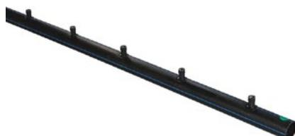
Коллектор для систем снеготаяния с ответвлениями под полимерные трубы диаметром 25 мм. Выполнен из полиэтилена высокой плотности (HDPE). Максимальная рабочая температура теплоносителя 50°C. Рабочее давление 4 бара. Муфты арт. 1136045 для подключения полимерных труб 25мм необходимо заказывать отдельно.
