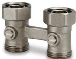
Узел для подключения к радиатору с нижней подводкой. Прямое исполнение, без байпаса. Имеет встроенные запорные краны. Подключение к радиатору - накидная гайка G3/4"НГ, подключение к трубам - наружная резьба G3/4""HP Евроконус для подключения зажимных адаптеров 3/4""ВР Евроконус. Для подключения к радиаторам с внутренней резьбой 1/2""ВР следует дополнительно использовать переходные ниппели G3/4""HP-G1/2""HP.
