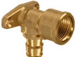
Фитинги из латуни для подключения труб из сшитого полиэтилена РЕ-Ха к санитарным приборам. Технология соединения трубы с фитингом основана на способности труб из сшитого полиэтилена восстанавливать свою первоначальную форму после расширения благодаря молекулярной памяти. Внутренняя резьба – трубная цилиндрическая Rp по DIN EN 10226-1, ГОСТ 6211.
