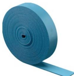
Демпферная лента из пористого полиэтилена для герметичного крепления к стене. Имеет клейкую тыльную сторону и продольный фартук из полиэтиленовой пленки. Укладывается по периметру помещения между стяжкой и смежными строительными конструкциями.
