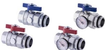
Изготавливается из покрытой латуни. Прямое исполнение. Наружная резьба 1"НР, внутренняя резьба 1"ВР. Наружная резьба со встроенной торцевой уплотнительной прокладкой под плоское уплотнение. Длина 92 мм. В комплект входят два крана. Арт.1135963 имеет встроенный термометр со шкалой 0÷80°C.
