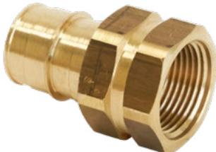
Фитинги из латуни для соединения труб из сшитого полиэтилена РЕ-Ха с отопительными и санитарными приборами, резьбовыми коллекторами, запорно-регулирующей арматурой и т.п. Технология соединения трубы с фитингом основана на способности труб из сшитого полиэтилена восстанавливать свою первоначальную форму после расширения благодаря молекулярной памяти. Внутренняя резьба – трубная цилиндрическая G по DIN EN ISO 228-1, ГОСТ 6357.
