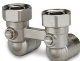
Узел для подключения к радиатору с нижней подводкой. Угловое исполнение, без байпаса. Имеет встроенные запорные краны. Подключение к радиатору - накидная гайка G3/4"НГ, подключение к трубам - наружная резьба G3/4""HP Евроконус для подключения зажимных адаптеров 3/4""ВР Евроконус. Для подключения к радиаторам с внутренней резьбой 1/2""ВР следует дополнительно использовать переходные ниппели G3/4"HP-G1/2"HP.
