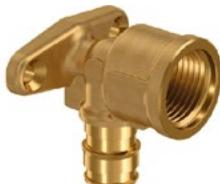
Фитинги из латуни для подключения труб из сшитого полиэтилена РЕ-Ха к санитарным приборам. Технология соединения трубы с фитингом основана на способности труб из сшитого полистиленса восстанавливать свою первоначальную форму после расширения благодаря молекулярной памяти. Внутренняя резьба – трубная цилиндрическая Rp по DIN EN 10226-1, ГОСТ 6211.
