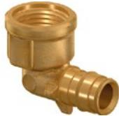
Фитинги из латуни для соединения труб из сшитого полиэтилена РЕ-Ха с отопительными и санитарными приборами, резьбовыми коллекторами, запорно-регулирующей арматурой и т.п. Технология соединения трубы с фитингом основана на способности труб из сшитого полиэтилена восстанавливать свою первоначальную форму после расширения благодаря молекулярной памяти. Внутренняя резьба – трубная цилиндрическая Rp по DIN EN 10226-1, ГОСТ 6211.
