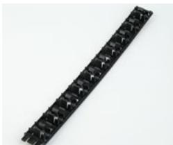
U-образная планка из полипропилена для крепления полимерных труб 16-20 мм. сто крепится к рабочей поверхности, например, анкерами. Межосевое расстояние между фиксаторами 50 мм, длина тракам. Отдельные траки стыкуются между собой с помощью защёлки.
