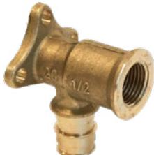
Фитинги из латуни для подключения труб из сшитого полиэтилена РЕ-Ха к санитарным приборам. Технология соединения трубы с фитингом основана на способности труб из сшитого полиэтилена восстанавливать свою первоначальную форму после расширения благодаря молекулярной памяти. Внутренняя резьба – трубная цилиндрическая G по DIN EN ISO 228-1, ГОСТ 6357.
