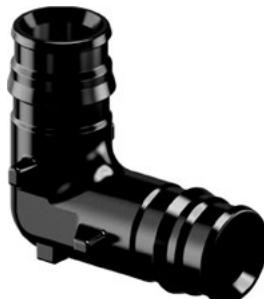
Полимерные фитинги из полифенилсульфона PPSU для соединения труб из сшитого полиэтилена PE-Xa. Технология соединения трубы с фитингом основана на способности труб из сшитого полиэтилена восстанавливать свою первоначальную форму после расширения благодаря молекулярной памяти. Фитинги универсальны для труб серий S5,0 и S3,2 (PN6 и PN10). Кольца для монтажа следует заказывать отдельно.
