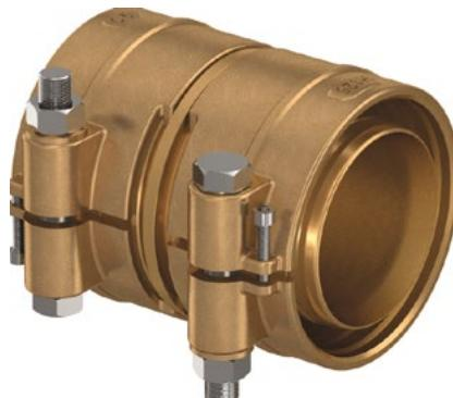
Для соединения труб PE-Xa и PE-HD серий S5,0 (PN6) и S3,2 (PN10). Состоит из двух обжимных гильз, штуцера из стойкой к обесцинкованию латуни по DIN EN ISO 6509 и двух болтов из нержавеющей стали.
