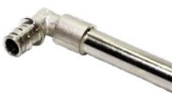
Изготавливается из трубы 15 x 1 мм длиной 250 мм. Подключение медной трубы 15 x 1 мм к радиаторному узлу 3/4"ВР Евроконус необходимо выполнять резьбовым адаптером 15Cu. Технология соединения трубы с фитингом основана на способности труб из сшитого полиэтилена восстанавливать свою первоначальную форму после расширения благодаря молекулярной памяти. Кольцо следует заказывать отдельно.
