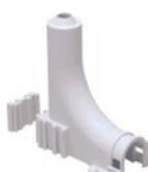
Изготавливается из пластика. Для фиксации загиба труб PE-Xa диаметром 16 мм при подключении к радиатору. Разборный, для кожуха 25/20 мм. Минимальное межосевое расстояние между трубами при использовании двух фиксаторов - 40 мм, включая 5 мм зазор между фиксаторами. В комплект входит один фиксатор.
