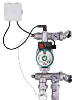
Насосно-смесительный блок в комплекте с терmostатической головкой для поддержания постоянной температуры на подаче в системе напольного, настенного и потолочного отопления. Для арт. 1135960 насос следует приобретать отдельно: монтажная длина - 130 мм, насос с наружной резьбой 1 1/2" НР.
