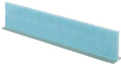
Состоит из самоклеющеся трака из ПЭТ и ленты из вспененного полиэтилена толщиной 10 мм, для установки в температурно-деформационных швах (например, дверных проёмах) и компенсации расширения стяжки.
