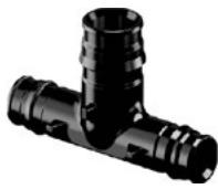
Полимерные фитинги из полифенилсульфона PPSU для соединения труб из сшитого полиэтилена PE-Ха. Технология соединения трубы с фитингом основана на способности труб из сшитого полиэтилена восстанавливать свою первоначальную форму после расширения благодаря молекулярной памяти. Фитинги универсальны для труб серий S5,0 и S3,2 (PN6 и PN10). Кольца для монтажа следует заказывать отдельно.
