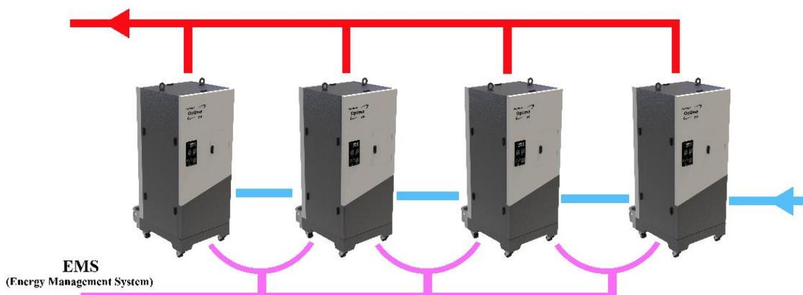
Автомат Honeywell MAXSYS использует общую базовую нагрузку скорости расхода (firing rate) для секвенирования и модерирования системы с несколькими котлами. Данный метод оптимизирует эффективность работы котлов, уменьшая потери энергии при коротких циклах. Устранение коротких циклов уменьшает потери на продувку и в режиме ожидания, а также продлевает срок службы котла.
